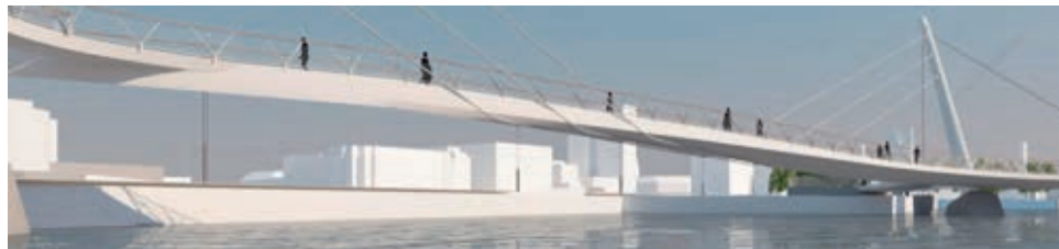
Bild 3. Illustrationen visar den unika lösningen med kablar som omsluter brobanan och "vagnar" bron mellan pylonerna och därmed utgör en mix av en hängbro och en snedkabelbro.
