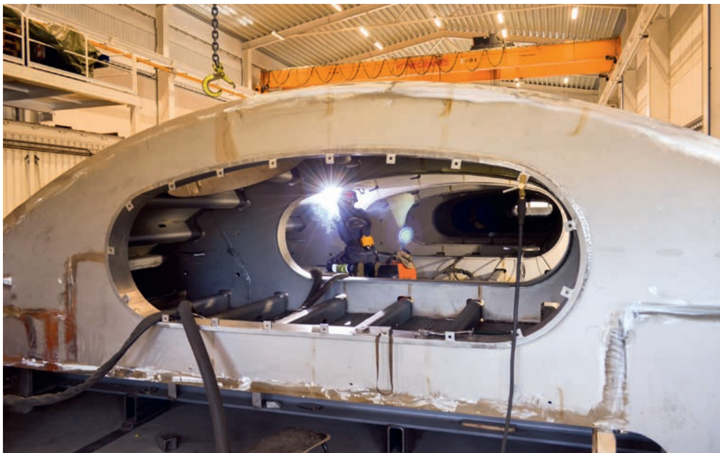
Dammluckan till Slussen i Stockholms ström är konstruerad helt i duplex. Den färdigställs på Stål & Rörmontage i Sölvesborg. Du kan läsa mer om det företaget i nummer 1-2022 av Svetsen
