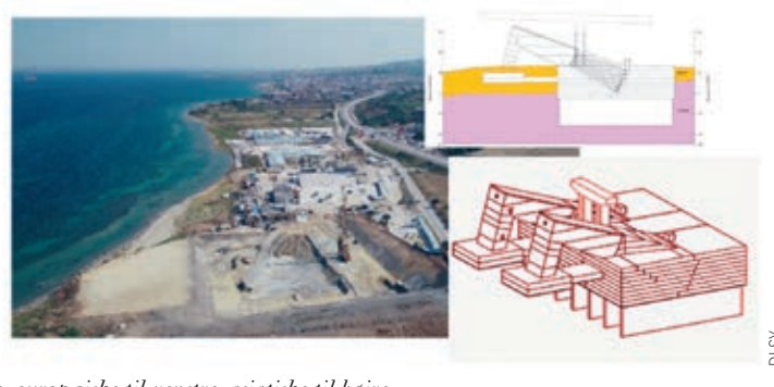
Figur 11: Jordbundsforhold og ankerblokke, europæiske til venstre, asiatiske til højre
