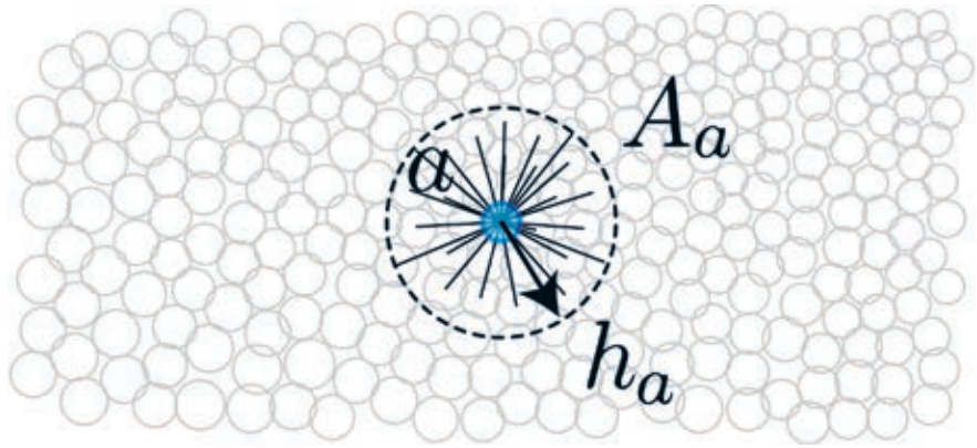
Figur 3: En partikel a omgiven av ett fält med partiklar av varierande storlek. Armarna som kopplar samman partikel a med sina grannar är markerade med svarta linjer. Partikeln räckvidd kallas dess horisont och definieras av arean A_a genom radien h_a .
