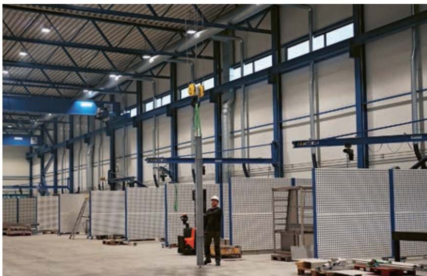
Sveisehallen har 25 sveisebåser med kraner og avsug, og sentralanlegg for gass, så man slipper å bytte og løfte på gassflasker til sveiserne.
