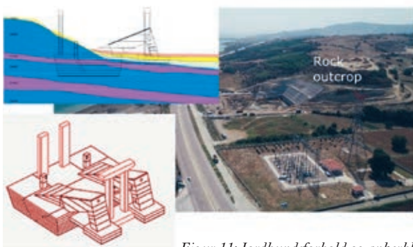
Figur 11: Jordbundsforhold og ankerblokke, europæiske til venstre, asiatiske til højre
