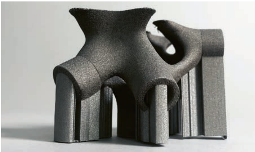
Figur 2: Prototyp av en 3D-printad stålnod med kapacitet att överföra krafter från 9 stänger och med varierande vinklar mellan stängerna. Prototypens vertikala stöd behövs vid tillverkningen för stabilitet och för att leda bort den värme som utvecklas när en laser smälter stålpulvret under printningsprocessen.
