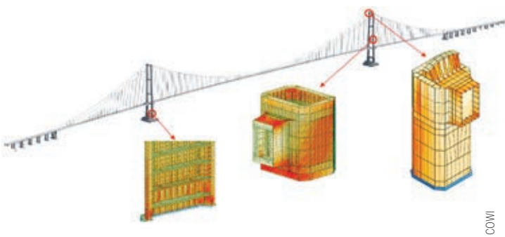
Figur 9: Eksempel på lokale FE-modeller brugt til verifikation af ståltårnene
