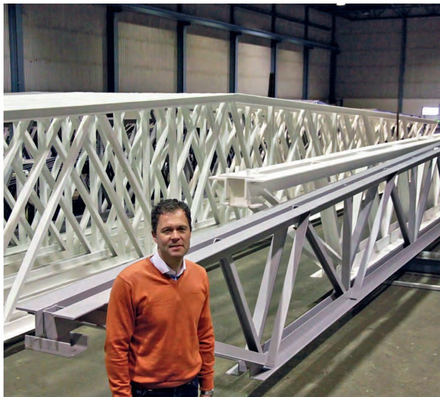
Jörgen Svensson är platschef för säljverksamheten och tillverkningen i verkstaden. Fackverk klara för leverans. De vita fackverken som ses i bakgrunden är brandskyddsmålade och ska levereras till Kilenkryssets byggarbetsplats i Upplands-Bro.
