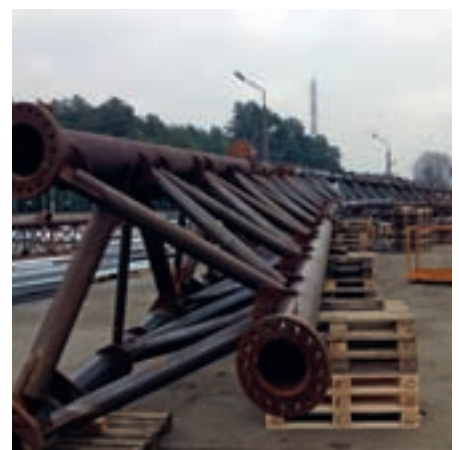
Det först tillverkade stolpbenet provmonteras på fabriken i Polen.
