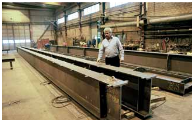
Räcke-konstruktionen till Sölvesborgsbron under tillverkning inne i Stål & Rörmontages verkstad
