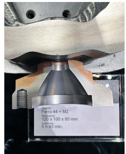
En delvis kuttet multimaterial del som er hybridfremstilt.
