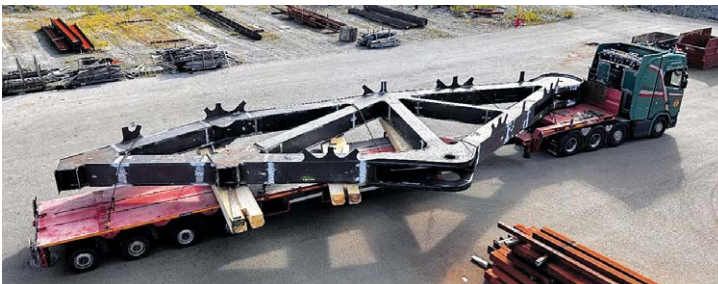
Lecor tillverkade motviktar och motvikt-lådor i två delar i verkstaden i Kungälv för transport till PMK Marin i Landskrona.
