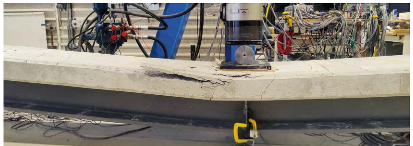
Testbalk vid brottlast. Flytning i stålet och krossbrott i betongplattans överkant.
