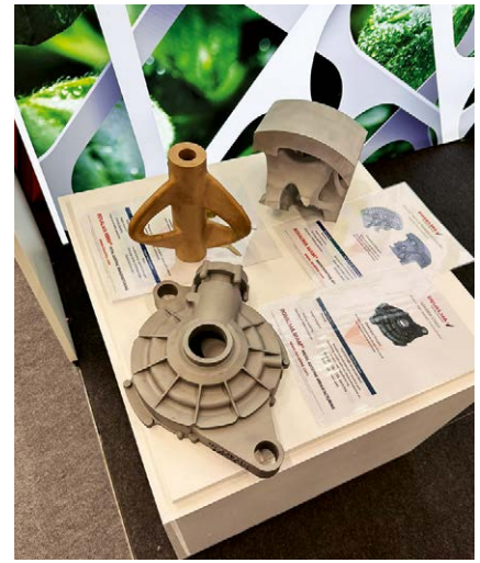
Demonstrasjonsdeler som viser volumetriske 3D-printing som muliggjør komplekse geometrier. Vi ser en lukket båt propell, et deksel til girboks og en topologioptimalisert verktøyforminnsats for metalforming.
