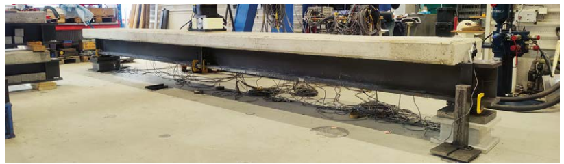
Försöksuppställning - balk i trepunktsböjning.
