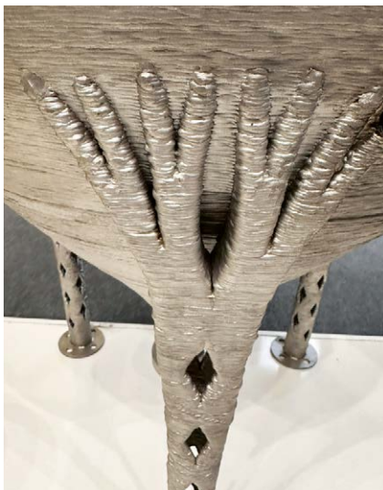
Benstruktur med fingrer som griper i tanken – topologioptimalisert.
