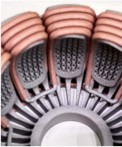
Detaljebilde av viklinger med kobberledere som er støttet opp av en 3D-printet ramme.
