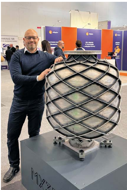
Viser en trykktank produsert med MX3D sin Wire Arc AM teknologi og artikkel forfatter.
