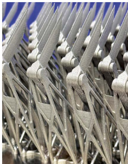
3D-printet kuttekniver med avansert topologi-optimalisert design.
