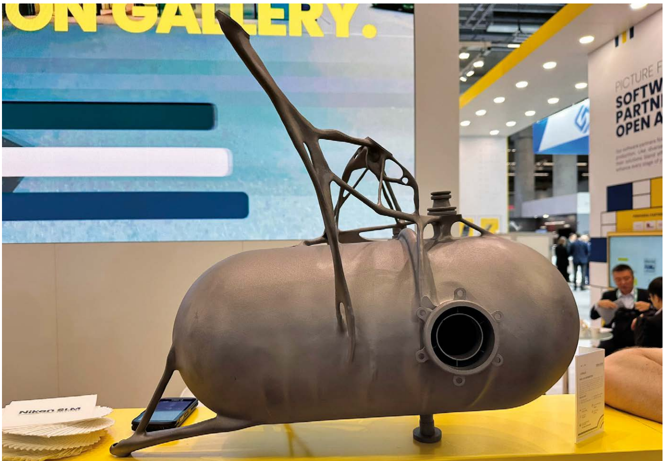
En 3D-printet drivstoff-og luftseparator brukt i flyindustrien for Airbus A330s - enheten skiller vann fra parafin - Inspirert av Minions kanskje.
